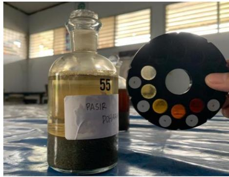
**Gambar 1** Pengujian Kotoran Organik Pada Agregat Kasar
